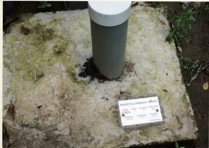
▲ ボーリング調査跡。真ん中のグレーの筒の下に964.5mの深さの穴があいている。
